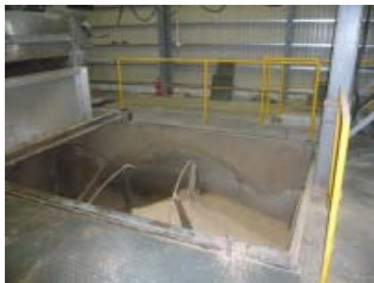
右：写真 3-2 混練機 生ゴミと水分調整材，種菌を混ぜ合わせる。
