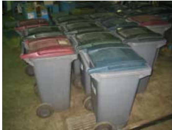
写真 6-12 東京農大式生ごみ肥料化プラント 収集バケツ袋を使わないためプラスチックごみの混入を避けることができる。
