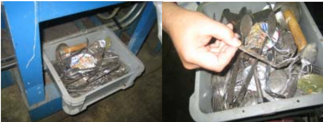
左：写真 6-13 東京農大式肥料化プラントにおける混入物 右：写真 6-14 東京農大式肥料化プラントにおける混入物拡大
